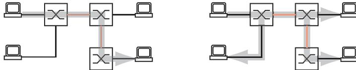
Abb. 76: MAC-Datenvermittlung: Unicast-Datenpaket (links) und Broadcast-Datenpaket (rechts)
